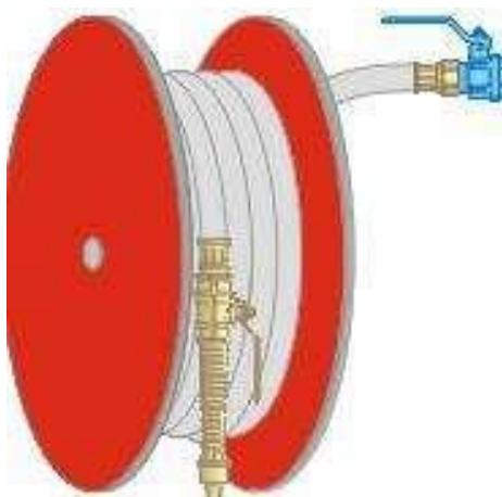
Le principali attrezzature per lo spegnimento degli incendi sono realizzate da tubature flessibili avvolte che collegano tubazioni con acqua in pressione ed erogatori capaci di lanciare l’acqua a distanza e perciò chiamati “lance” da incendio.
